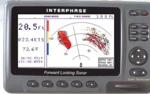
Geteilte Anzeige: aktuelle Tiefe unter dem Schiff (links) und horizontaler Vorwärtssuchlauf (rechts).
