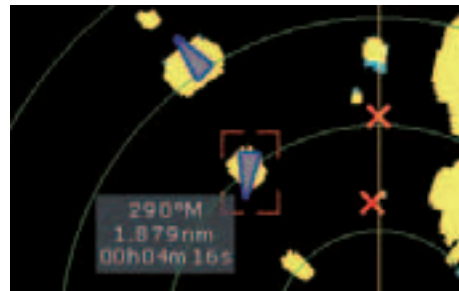
Overlay von AIS-Zielen mit Radar-Kontakten auf Raymarine-Multifunktionsdisplays
