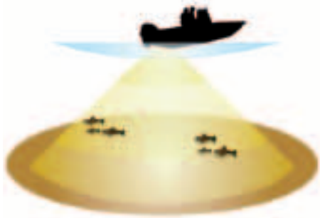
Sendekegel rotiert nach vorne und nach hinten
